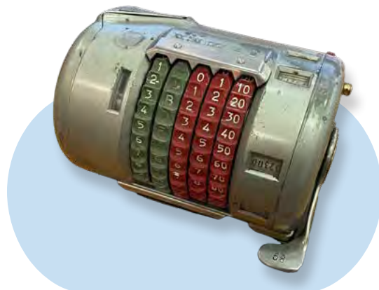
Mechanische Fahrscheindrucker (Hersteller ALMEX) ermöglichen die Einführung des Einmannbetriebs
