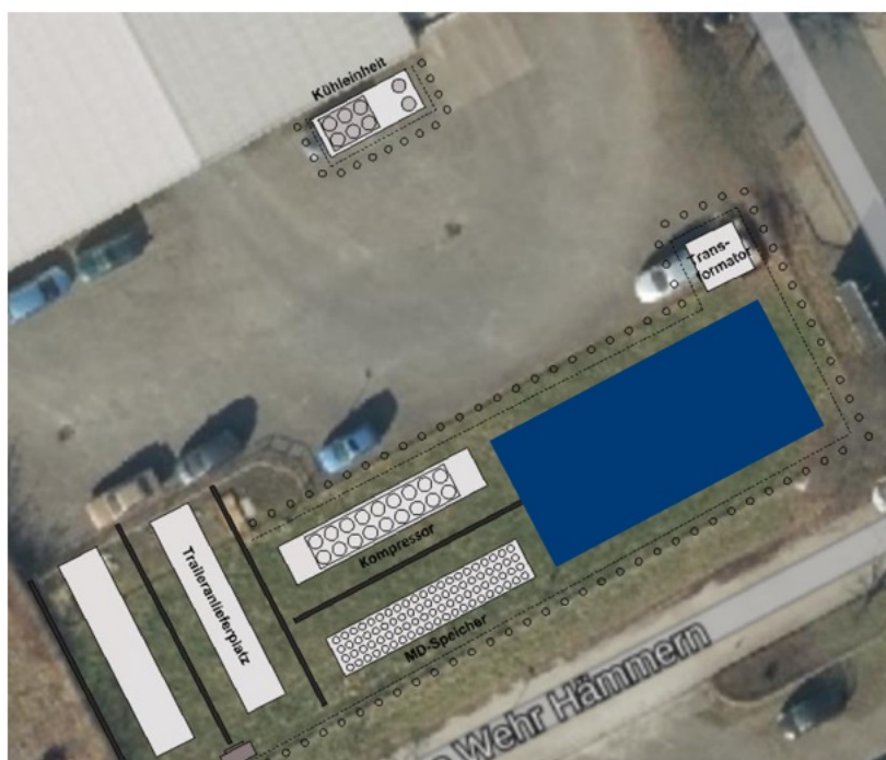
Abbildung 4-2: Beispielhafte Aufstellung der H 2 -TS am Standort Wipperfürth (Erste Ausbaustufe, ■BZ-Busse)
